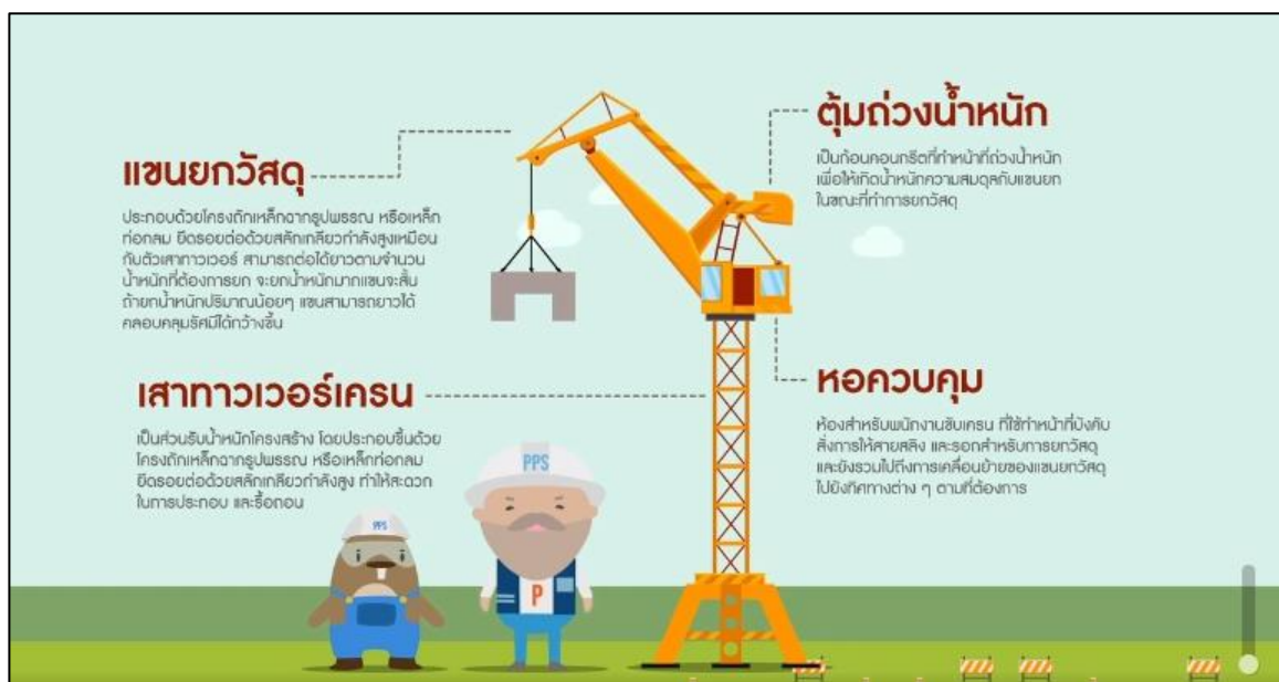
รูปที่ 2.13.3-3 ส่วนประกอบของทาวเวอร์ เครน (Tower crane) แบบบูมกระดก
